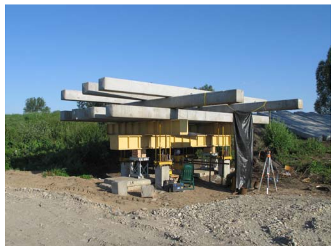
Fot. 6. Stanowisko do testu statycznego
