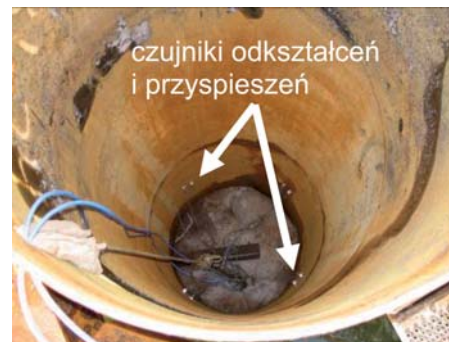
Rys. 4. Pal średnicy 1220 mm przygotowany do badania; czujniki umieszczone wewnątrz pala
