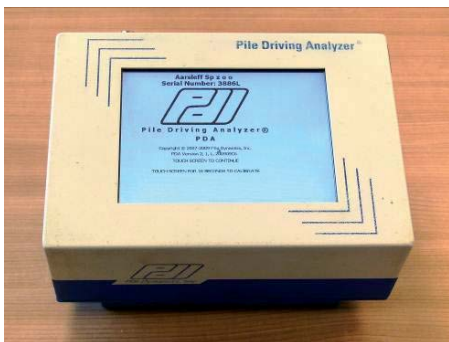
Rys. 2. Urządzenie PDA do rejestracji sygnału z czujników
