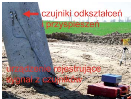
Rys. 3. Badanie pala ukończonego (Farma wiatrowa Kisielice)
